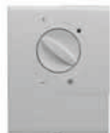
ART 2630 Plochý kryt z termorezistentního plastu, bílý (RAL 9010) Rozsah tepelné regulace 5–30 °C Automatická funkce ochrany proti zamrznutí 8 °C Rozdíl 0,5 K Čidlo NTC Přenosová frekvence 868,3 MHz Přenosový výkon 50 µW Běžný dosah v budově cca 50 m (na volném prostranství cca 300 m) Elektrické napájení – 2 alkalické baterie LR03 Životnost baterie cca 3 roky Elektrické krytí IP 20 (EN 60529) Třída III (EN 60760) CE – shoda s EN 300220-1 EN 300220-3
